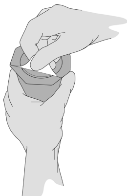
Рис. 8а. Отлепите наружную крышку
